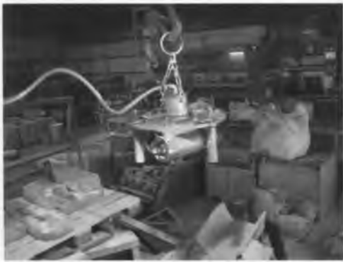
Рис. 2. Навесной пневмовибратор для механизированной набивки футеровки тигля индукционной печи
