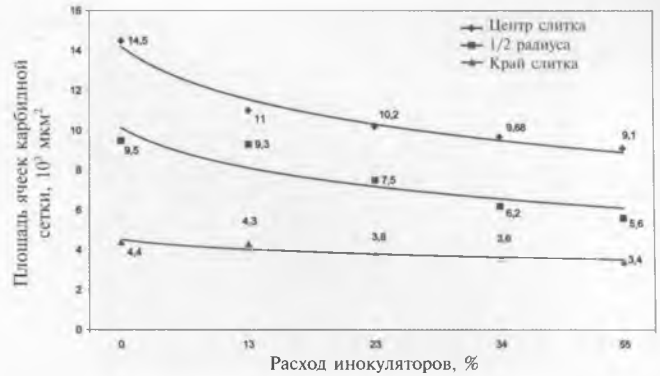
Рис. 8. Изменение площади ячеек карбидной сетки в слитке диам. 300 мм из стали X12MФ-Ш в зависимости от количества инокуляторов, вводимых в жидкую металлическую ванну при ЭШП
