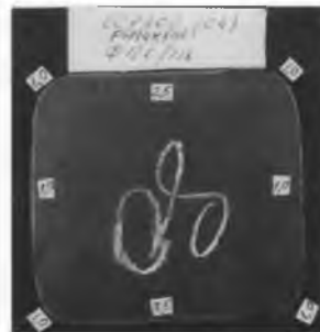
Рис. 5. Распределение обечайки на поверхности катаной заготовки со стороны квадрата 126 мм из стали P9M4K8-MP
