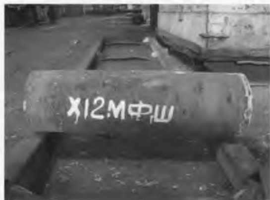
Рис. 4. Слиток диам. 300 мм из стали X12MФ-Ш, выплавленный с введением инокуляторов в процессе ЭШП
