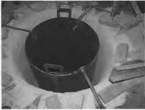
Рис. 1. Общий вид индукционной печи HFD-4 СПО ЦПМ с закрепленным металлическим шаблоном перед набивкой футеровки
