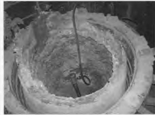
Рис. 8. Вид футеровки тигля после удаления буферного слоя
