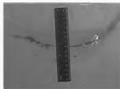
Рис. 5. Макроструктура и глубина металлической ванны слитка диам. 300 мм из стали X12MФ-Ш, выплавленного с введением инокуляторов в процессе ЭШП (пятый вариант плавки)
