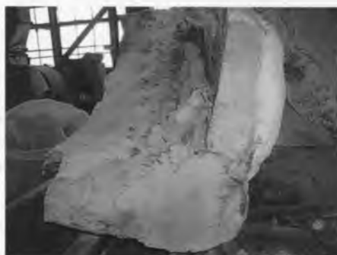
Рис. 6. Фрагменты отработанной футеровки тигля, выполненного ручным способом набивки
