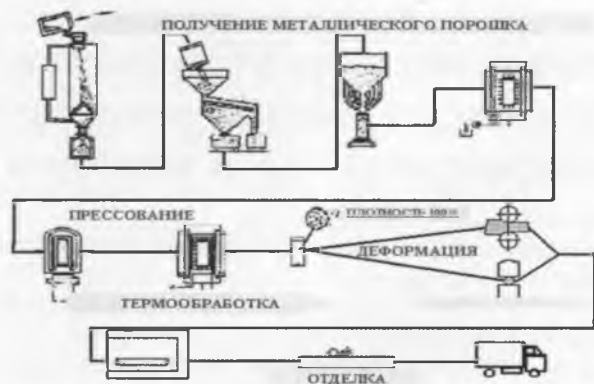
Рис. 4. Технологическая схема производства инструментальных сталей методом порошковой металлургии
