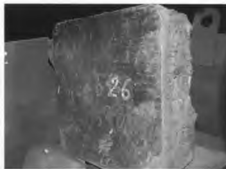
Рис. 5. Поперечное сечение слитка стали 08X18H10T в подготовленной зоне
